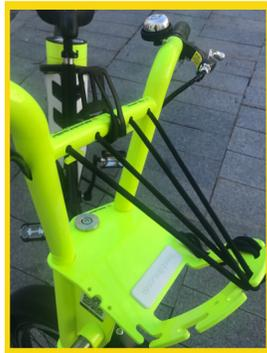
**Výšku sedadla** si jednoducho upravíte tak, že povolíte páčku pod ním, nastavíte správnu polohu a opäť zaistíte. V prednej časti nájdete **elastické popruhy**, ktorými môžete bezpečne priviazať menší náklad (kabelku, tašku, vak...). V strede volantu je umiestnený **flexibilný držiak na váš mobil**.
